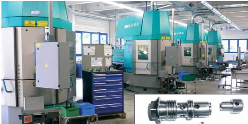
Werkstücke, die zum Zeitpunkt unseres Besuches auf den vier neuen INDEX-CNC-Mehrspindlern vom Typ MS32C bei der Firma Wagner liefern
